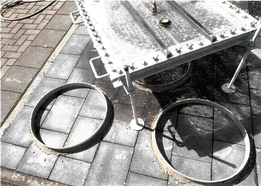
**Foto 2: Infiltrationsmessgerät Versuchsdurchführung**
