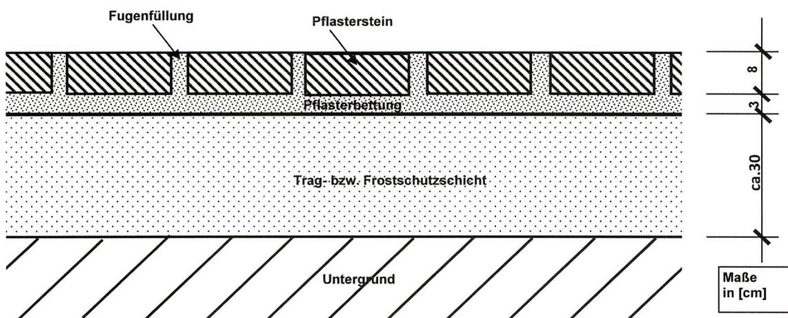
Abb. 1: Aufbau des Versickerungssystems (Prinzipskizze)
