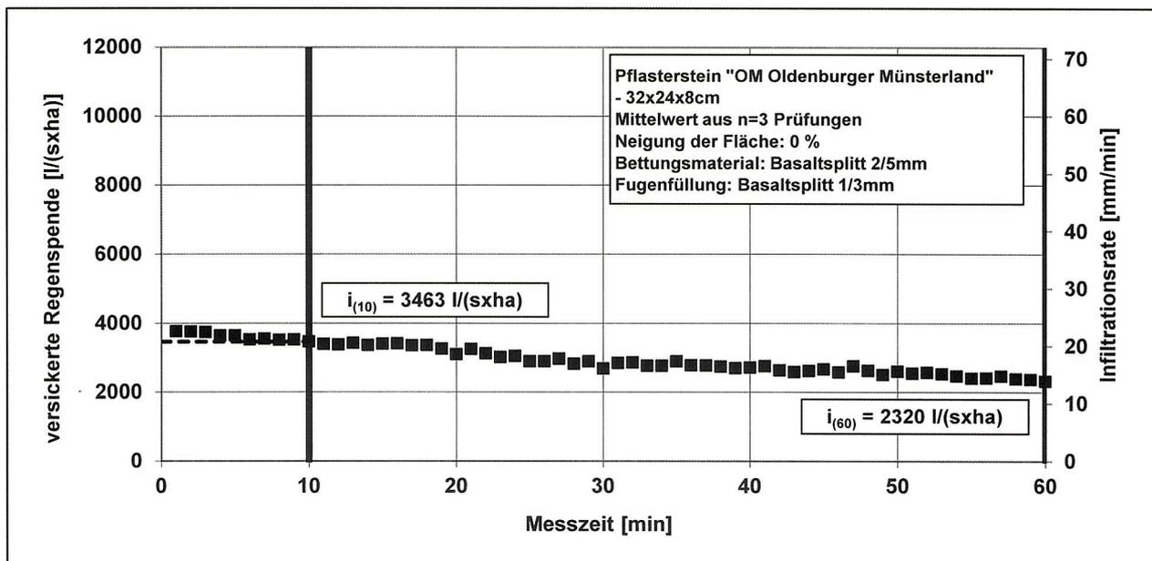
**Abb. 3: Ergebnisse der Infiltrationsmessung**
