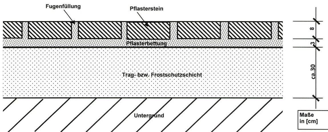
Abb. 1: Aufbau des Versickerungssystems (Prinzipskizze)
