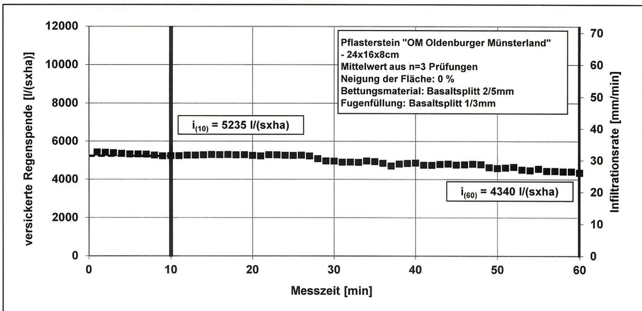
**Abb. 3: Ergebnisse der Infiltrationsmessung**
