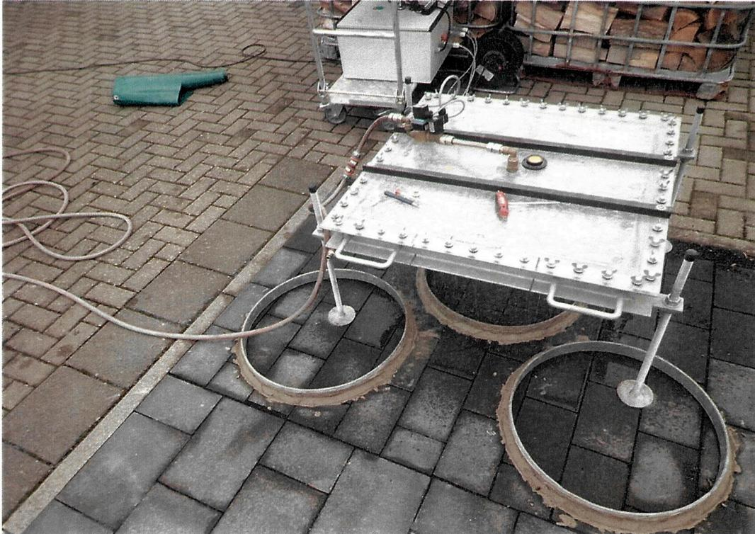
**Foto 2: Infiltrationsmessgerät Versuchsdurchführung**
